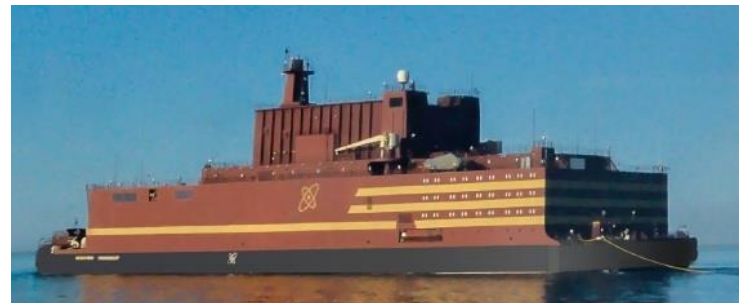
Plovoucí elektrárna Akademik Lomonosov – 2x reaktor KLT-40 (2x 38 MWe)
