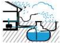
Nádrže na dešťovou vodu
