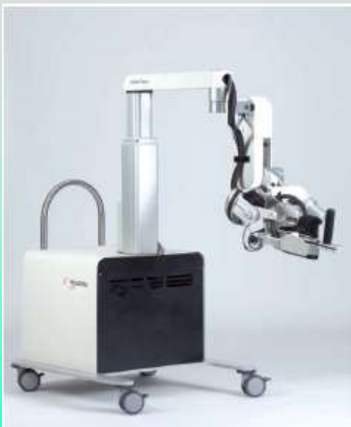
Přístroj ARMEO švýcarské společnosti HOCOMA pro roboticky asistovanou rehabilitaci pohybu horní končetiny s motivační zpětnou vazbou
