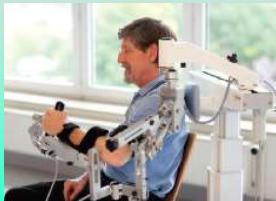
Přístroj ARMEO švýcarské společnosti HOCOMA pro roboticky asistovanou rehabilitaci pohybu horní končetiny s motivační zpětnou vazbou
