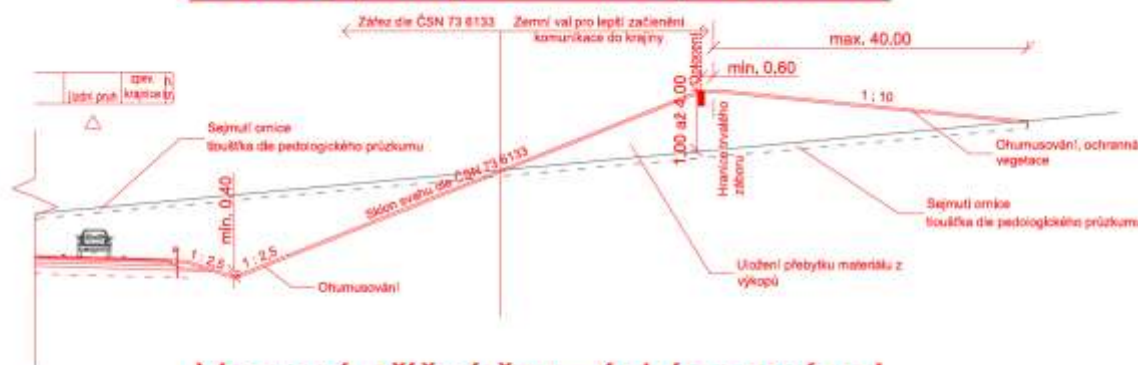
Vzorový příčný řez - úzký zemní val
