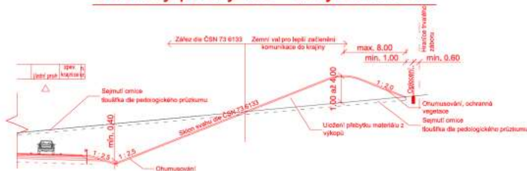
Vzorový příčný řez - úzký zemní val
